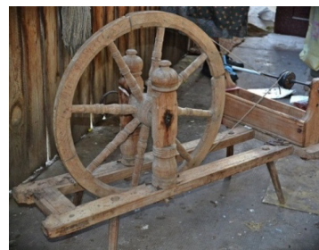
Roata pentru tras fire pe țeghii la război.
